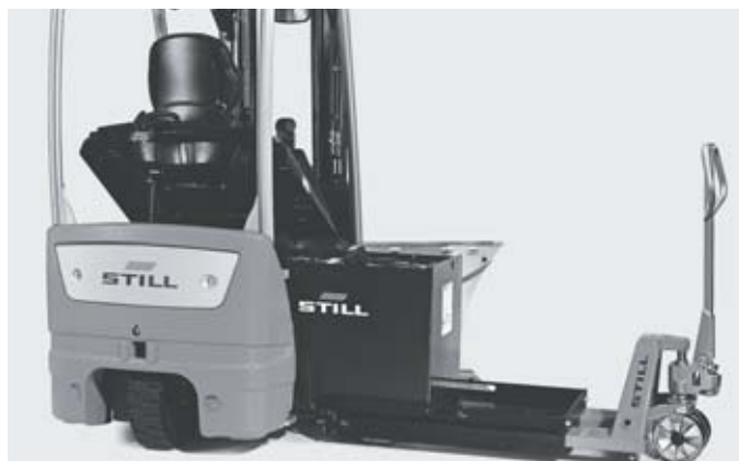
Простая замена АКБ сбоку при помощи стандартных ручных тележек и стэнда для замены АКБ
