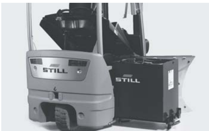
Секция АКБ для боковой замены аккумулятора при помощи крана
