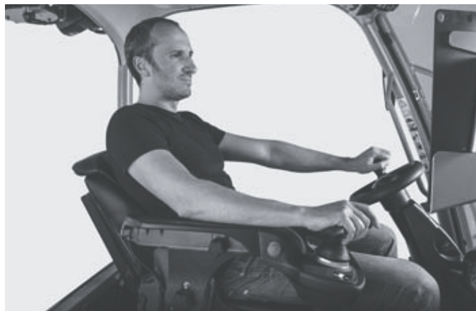
Джойстик 4Plus с подлокотником для работы с навесными устройствами без приложения усилий
